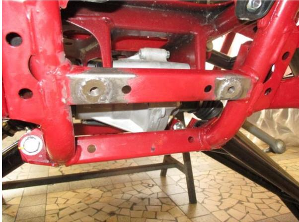
Soudure des canons avant
