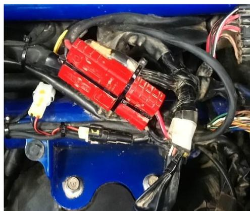
Couper les deux connecteurs et les remplacer par le connecteur fourni en respectant la couleur des fils.
